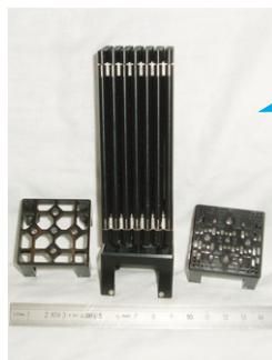
Simulation de la partie basse d'un assemblage combustible et embouts
